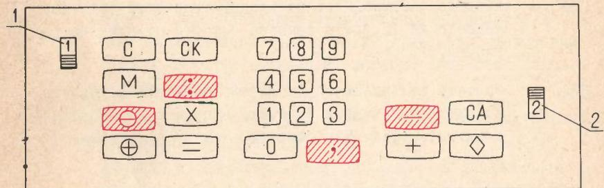
Клавиатурата на двата калкулатора "ЕЛКА 22" и "ЕЛКА 25" е абсолютно еднаква. Тя се състои от клавиши за въвеждане на данните /цифрова клавиатура/ и от клавиши за управление на операциите /операционни клавиши/. Функционалното предназначение на всеки клавиш в двата калкулатора е едно и също, ако не смятаме за различие цифровата индикация и печата на входните и изходни данни съответно при "ЕЛКА 22" и "ЕЛКА 25".
