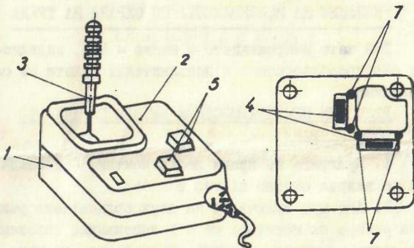
При преместване на ръчката (лоста) за управление в ляво репера на монитора се премества също в ляво по хоризонталната ос " X " . Ако това не се наблюдава, изважда се куилунга и се включва на  $180^{\circ}$  в цикъла на компютъра . При преместване на ръчката в дясно, репера на монитора се премества също в дясно по хоризонталната ос " X " .
